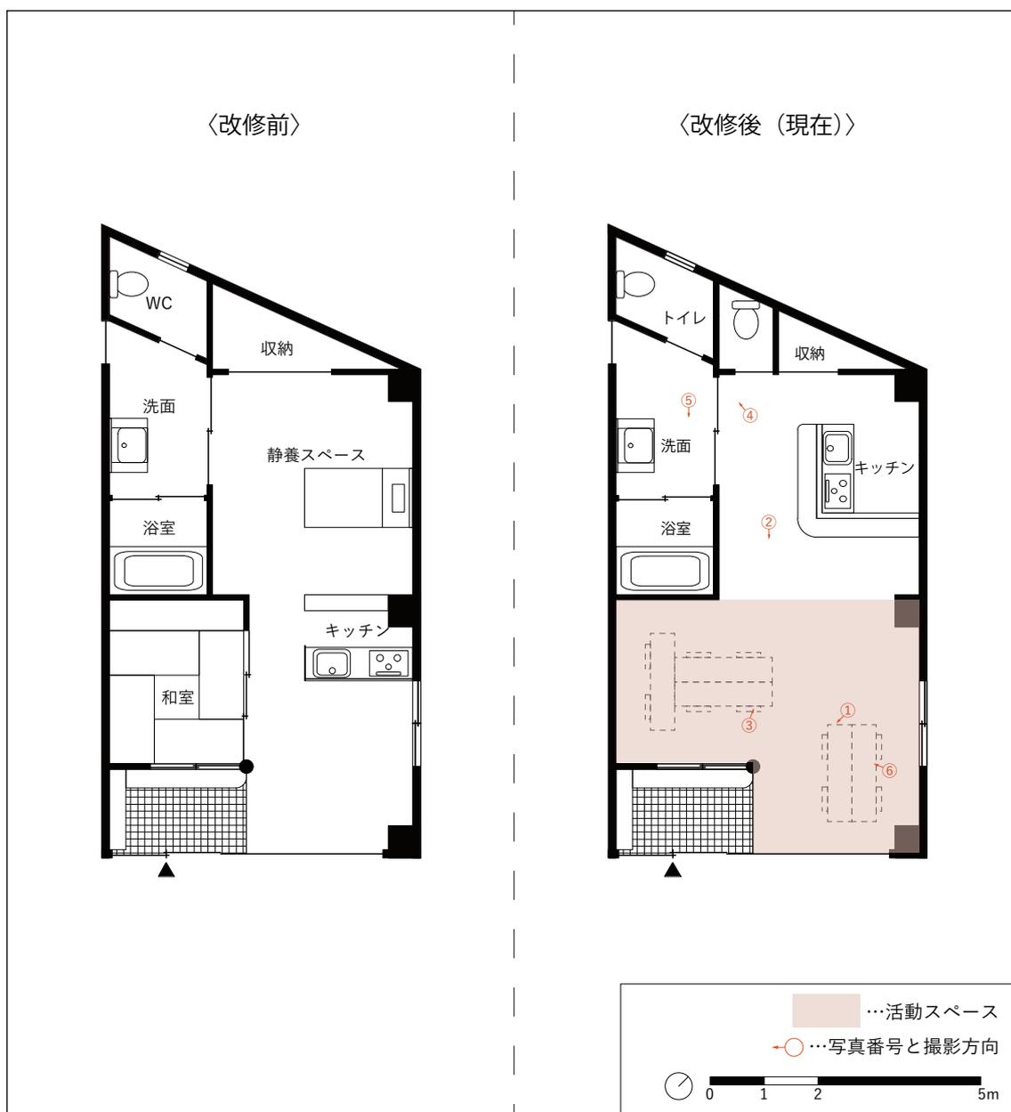
図 3.2.1 事業所 b 平面図（改修前後）
